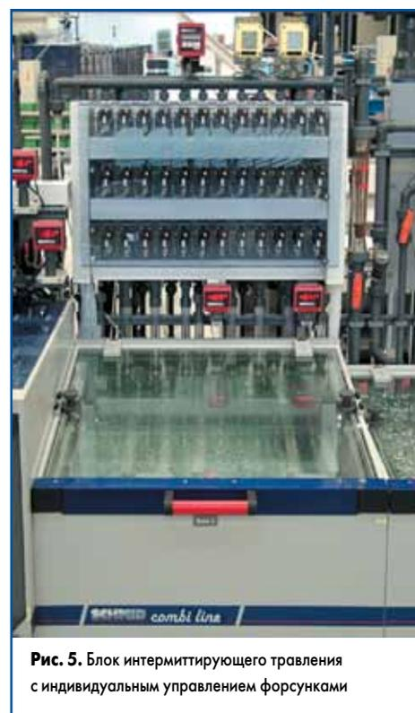
Рис. 5. Блок интермиттирующего травления с индивидуальным управлением форсунками
