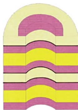
Рис. 5. Сквозное отверстие МПП после сверления
