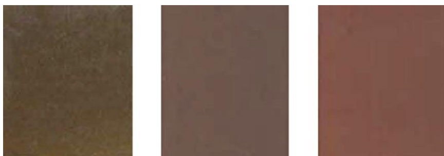
Рис. 10. Внешний вид адгезионных слоев: а) Circubond, б) Bond Film, в) Mec Etch Bond
