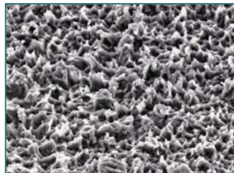
Рис. 9. Шероховатость поверхности меди после структурного микротравления (процесс фирмы MEC)
